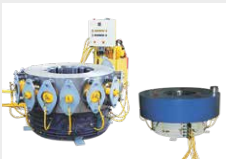
◀ Prensa de collar de alta precisión de 600 toneladas. Para la producción de bobinas de aceleración, las láminas de metal han de formarse en una forma y tamaño específicos.
