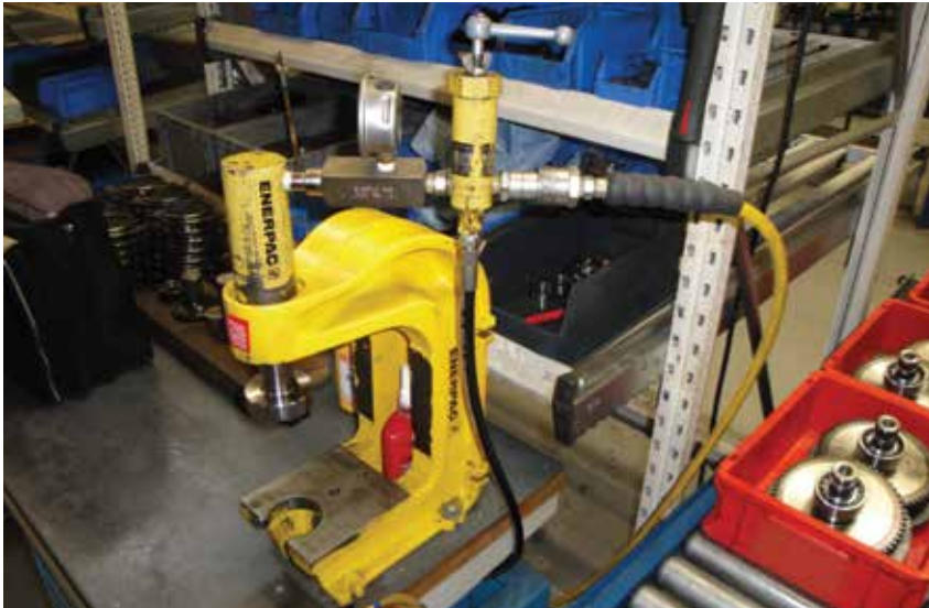
▲ Cilindro RC308 montado en una prensa de husillo A330 accionada por una bomba hidroneumática Turbo serie PATG para realizar una extracción controlada de rodamientos en ruedas dentadas de telares. La válvula V152 controla la presión de la operación.
