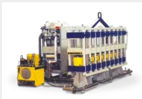
◀ Presse entièrement automatique de haute précision à automate (1800 tonnes). Le cycle de pressage et de chauffage, lors de la production de bobines d'accélération magnétiques, nécessitait une grande force et une grande précision pour garantir une qualité absolue.
