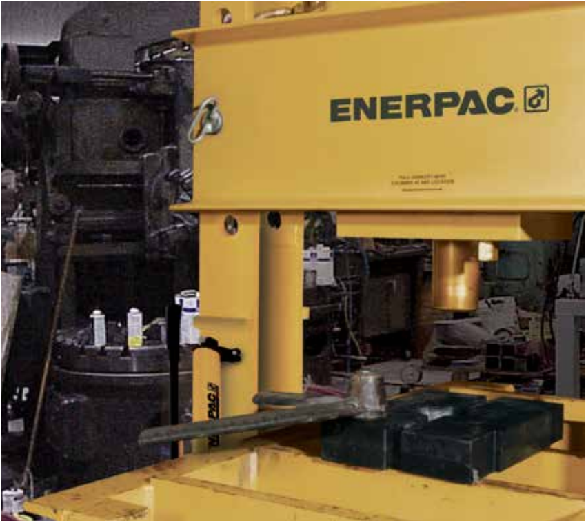
▲ Uma prensa de mesa com armação deslizante IPR20075 é usada para remover um eixo grande deste conjunto de mancal. O projeto da prensa de armação deslizante permite que se possa carregar, com um guindaste, partes pesadas, com segurança.
