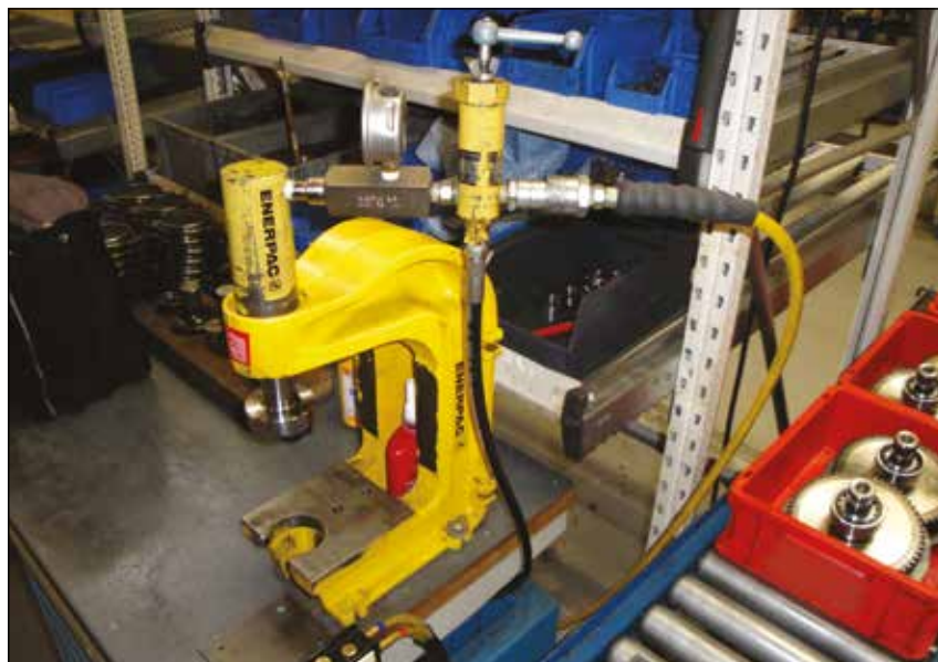
▲ Цилиндр RC308 в оправочном прессе A330 с приводом от пневматического насоса PATG-Turbo для контролируемой выпрессовки и запрессовки подшипников ткацких станков. Предохранительный клапан V152 ограничивает усилие прессы.
