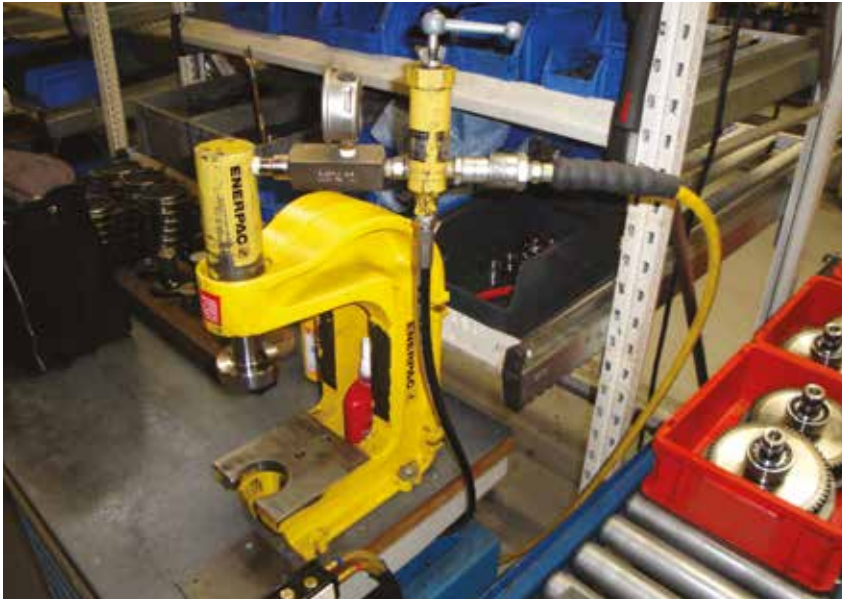
▲ RC308-cylinder monterad i en A330 C-press som drivs av en PATG-Turbo luftdriven hydropump för kontrollerad pressning av lager för kedjekanter i vävmaskiner. Tryckavlastningsventilen V152 kontrollerar pressningskraften.
