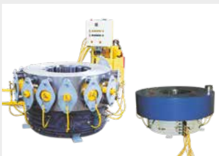
◀ 600-tons press med hög precision. För att tillverka acceleratorspoler måste plåt formas till en viss form och storlek.
