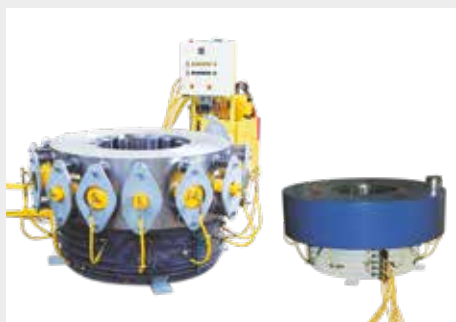
◀ 600 tonnin huipputarkka kauluspuristin. Kiihdytinkäämien valmistamiseksi metallilevystä on muodostettava tietty muoto ja koko.
