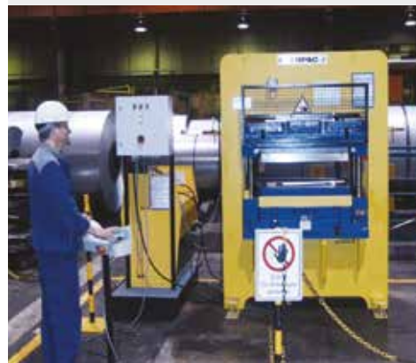
▲ Enerpacin hydrauliset puristimet voi räätälöidä monien erilaisten käyttökohteiden mukaan. Jokainen puristin on suunniteltu ja valmistettu asiakkaan vaatimusten mukaan yhdessä Enerpacin suunnittelutiimin kanssa.
