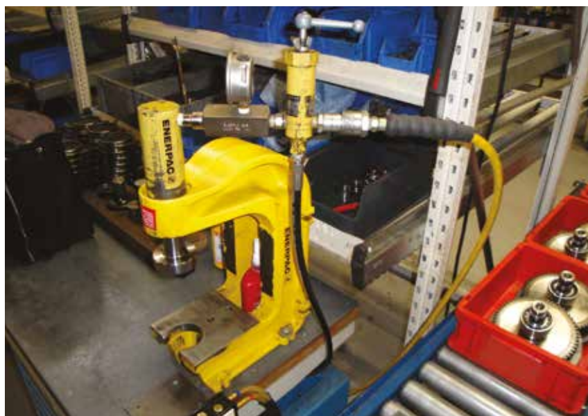
▲ Cilindro RC308 montato su pressa a collo di cigno A330 alimentato da una pompa pneumoidraulica PATG per una pressatura controllata dei cuscinetti nei pignoni delle macchine tessili. La forza di compressione è controllata tramite una valvola regolatrice di pressione V152.
