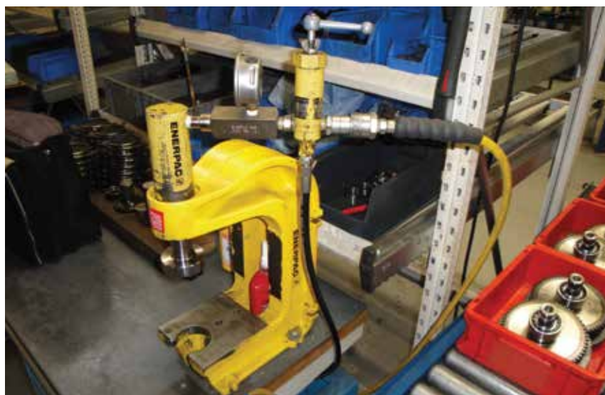
▲ Cilindro RC308 montado numa prensa de bancada modelo A330 acionada por uma bomba hidro-pneumática PATG Turbo II para realizar a prensagem controlada de rolamentos montados em rodas dentadas de máquinas de tecelagem. A válvula de alívio de pressão modelo V152 permite controlar a força de prensagem.
