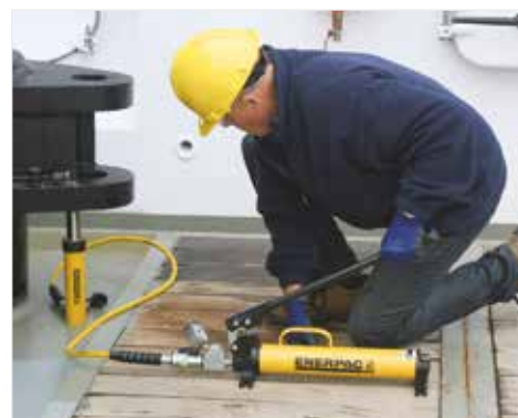
▲ Il nuovo gruppo adattatore manometro funge da finestra di monitoraggio del sistema per una lettura agevole della pressione e un impiego in sicurezza.
