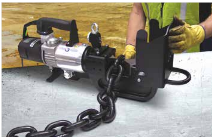
◀ Stříhače řetězů Enerpac umožňují snadné stříhání řetězů.
