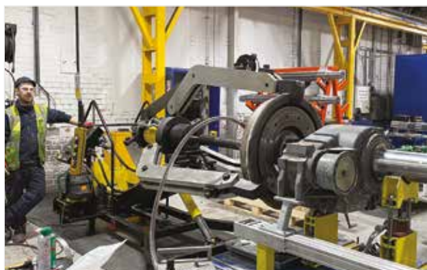
◀ LGH3100 utilizat pentru a extrage roata șinei de pe ax.
