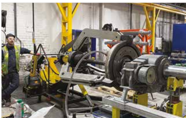
◀ LGH3100:lla poistetaan kiskopyörä akselilta.
