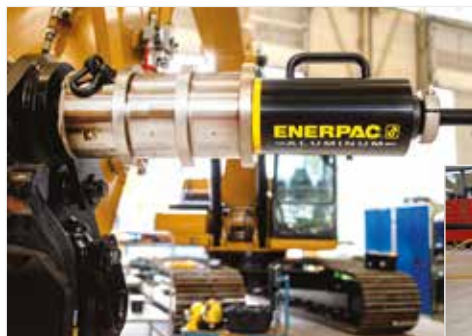
◀ Underhåll av grävmaskin med PPH40 som drivs av en sladdlös pump i SC-serien.
