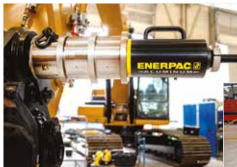
◀ Údržba rypadla pomocí PPH40 poháněného akumulátorovým čerpadlem řady SC.
