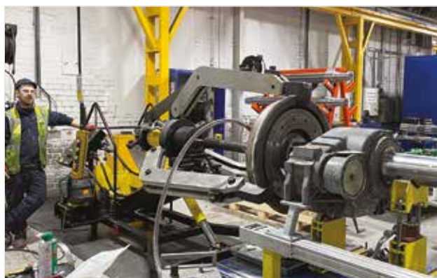
◀ Stahovák LGH3100 při demontáži železničního kola z nápravy.
