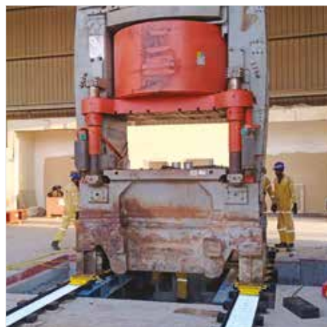
▲ Glidesystem brukes til å fjerne en gammel presse fra et anlegg for å gjøre plass til nytt utstyr.
