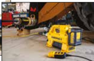
◀ Graafmachineonderhoud met behulp van de PPH40, aangedreven door een SC-serie accupomp.
