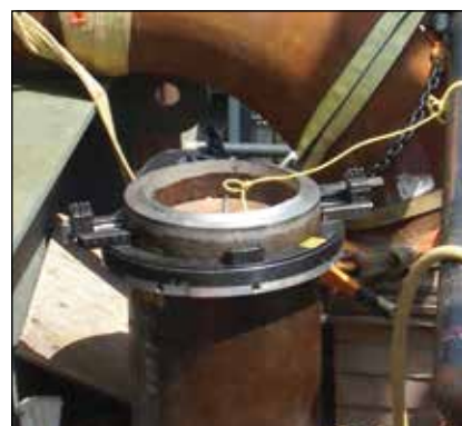
◀ Cortadora orbital de corpo delgado modelo NB.
