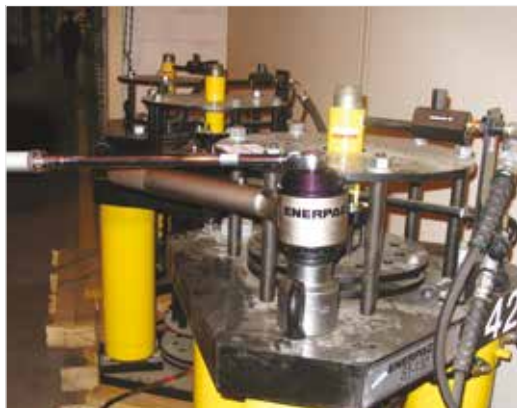
◀ Multiplicador de par con barra de reacción E393 de Enerpac utilizado para apretar a mano pernos con un par de hasta 3170 Ft.lbs.
