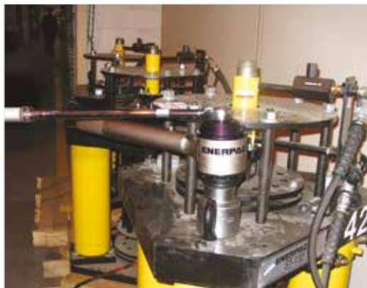
◀ Multiplicador de torque da barra de reação Enerpac E393 usado para apertar parafusos manualmente até 4300 Nm.
