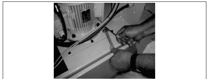
Abbildung 64: Lage der Entlüftungsschraube
