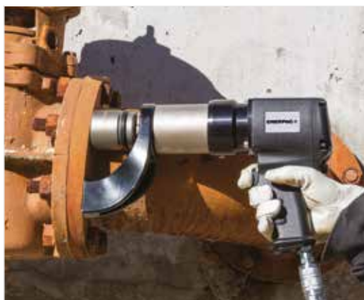
◀ La llave PTW1000 agiliza este trabajo de mantenimiento de bridas.
