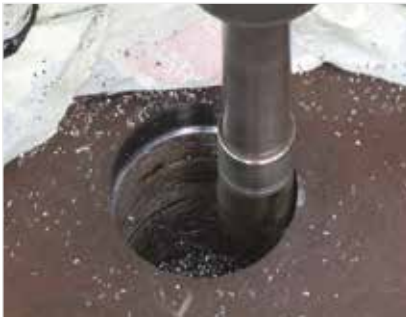
▲ Ampliación de un orificio
