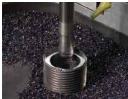
▲ Noyautage du centre d'un boulon (diamètre intérieur).
