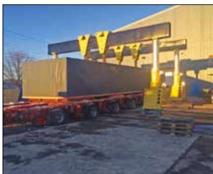
El pórtico de pluma hidráulica transporta de forma segura el asiento de una máquina de 120 toneladas
