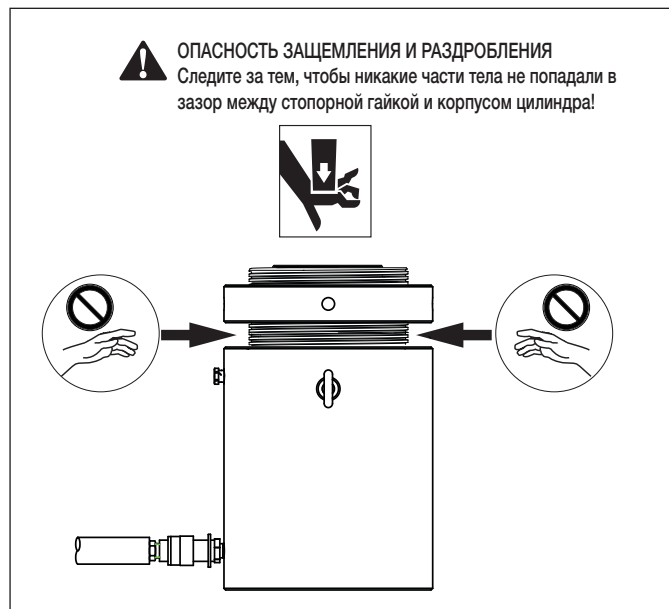
Рис. 1. Опасность защемления и раздробления
