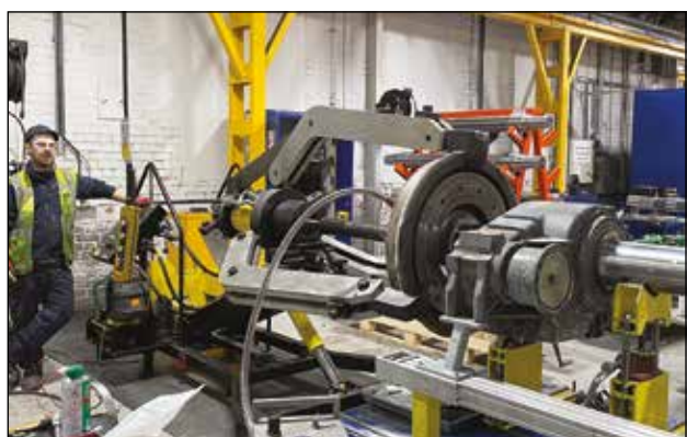
◀ LGH3100で軸から鉄道の車輪を取り外す作業。
