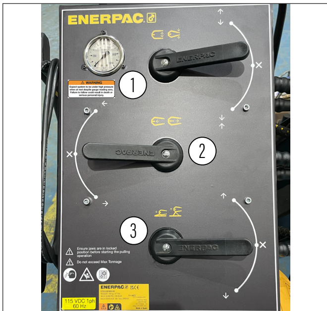
Figur 17: Fördelningsblock med delat flöde
