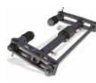
Conjuntos de ferramentas troca de válvulas
