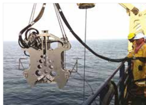
▲ Serra de fio diamantado MDWS abaixada no mar.
