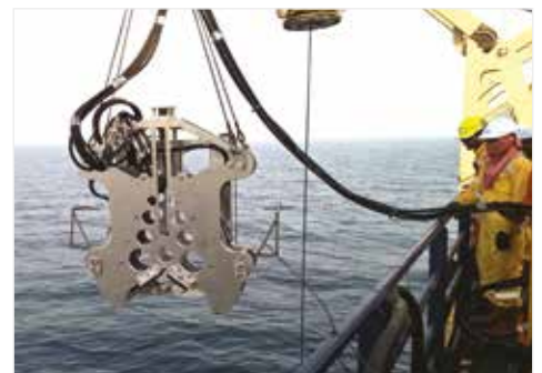
▲ Ins Meer abgesenkte MDWS-Diamantkettensäge.
