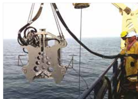
▲ Scie à fil diamanté MDWS immergée dans l'eau.
