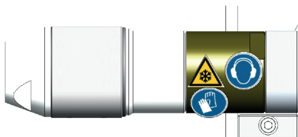
Obr. 2: Motor s umístěnými bezpečnostními štítky
