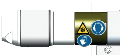
Figura 2: Motor con etiquetas de seguridad
