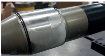
Abbildung 2: Frost/Eis am Motor
