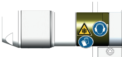
Illustration 1 : moteur avec des étiquettes de sécurité
