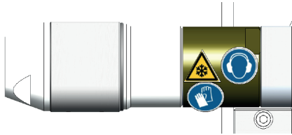
Illustration 1 : moteur avec des étiquettes de sécurité
