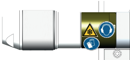
Figura 2: Motor con etiquetas de seguridad
