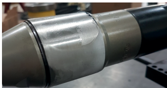
Illustration 3 : gel/glace sur le moteur
