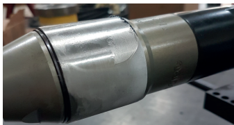
Figura 3: Helada/hielo en el motor
