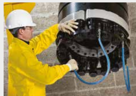
▲ Anwendungsbeispiel für das Vorspannen von mehreren Bolzen.
