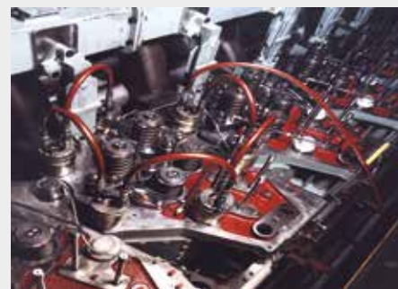
▲ Écrous hydrauliques sur moteur diesel
