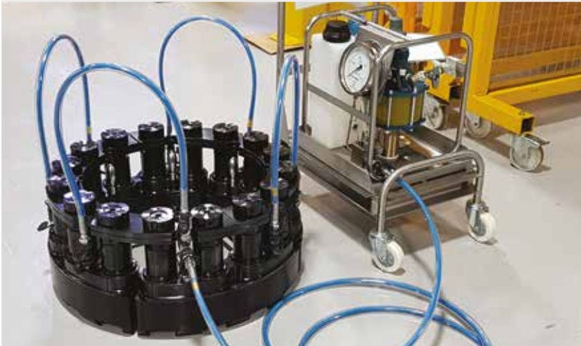
▲ Allestimento per il tensionamento di più bulloni.
