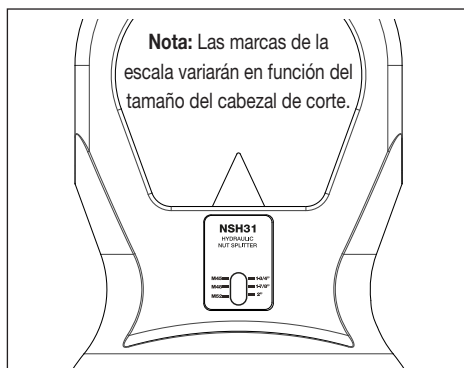
Figura 4: Escala de profundidad del corte de la cuchilla
