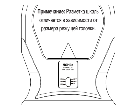
Рисунок 4: Шкала глубины резания режущего клина
