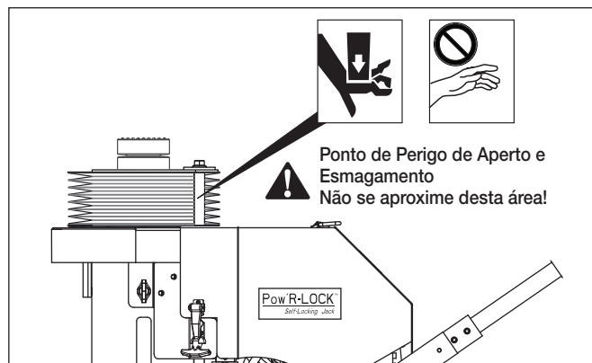
Figura 1, Ponto de Perigo de Aperto
