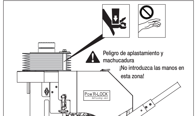
Figura 1, Peligro de machucadura
