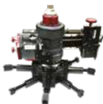
Flensinnrettingmaskiner for innvendig montering
