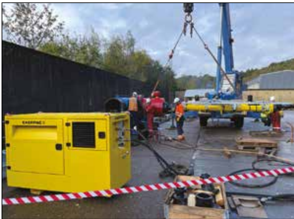
◀ Enerpac MHT2460-H – paineenalaisen haaroituksen kone, joka toimii PP44- sarjan koneikolla.
