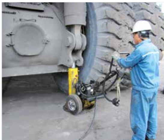
◀ Enerpac POW'R-RISER® utilizado en la minería para levantar equipos pesados.
