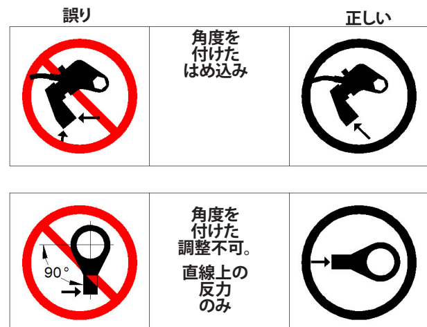
図4.4-2 リアクションアーム付き六角ツールの反力
