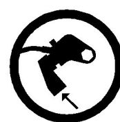
Fig. 4.4-2 Reacción de herramienta hexagonal con brazo de reacción
